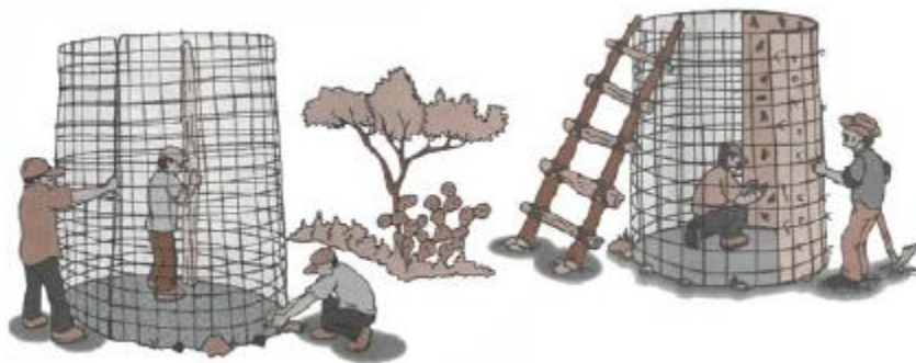
Imagen 2.- Colocación de la estructura del tanque y Repellado del tanque.
